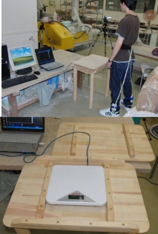
Fig.1 f-scan、体重計の取り付け位置
