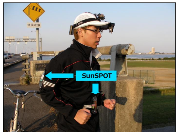
図 3：上腕と腰部分のワイヤレスセンサデバイス。
