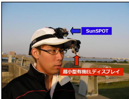
図 5: 超小型ディスプレイの装着例.
