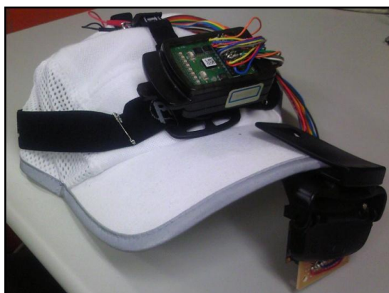
図 4: 超小型ディスプレイと情報出力用 SunSPOT.
