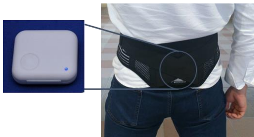
図 4 センサ取り付け位置
