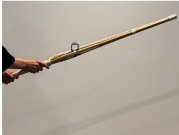
図 1: センサとマイコンを組み込んだ竹刀。
